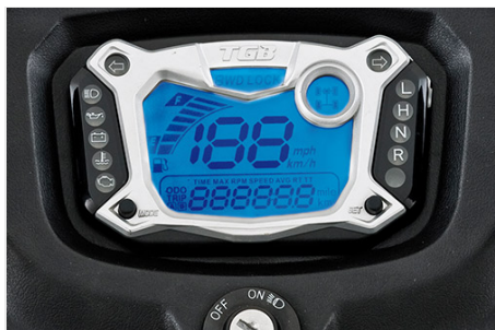
Blue-Backlight multifunktionale Digitalarmatur mit Drehzahlmesser und Tankanzeige
