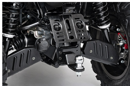
abnehmbare Anhängerkupplung und Steckdose, Einzelradaufhängung vorne und hinten
