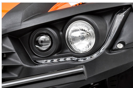
Polyellipsoid- und Halogenscheinwerfer mit LED-Tagfahrlicht
