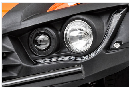
Polyellipsoid- und Halogenscheinwerfer mit LED-Tagfahrlicht
