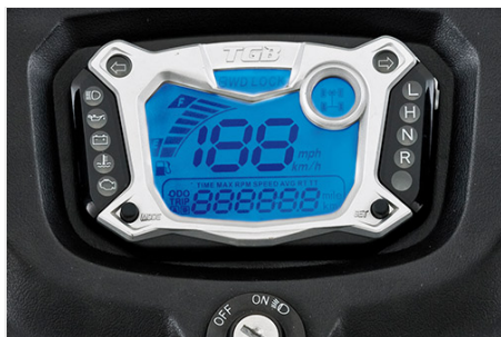
Blue-Backlight multifunktionale Digitalarmatur mit Drehzahlmesser und Tankanzeige
